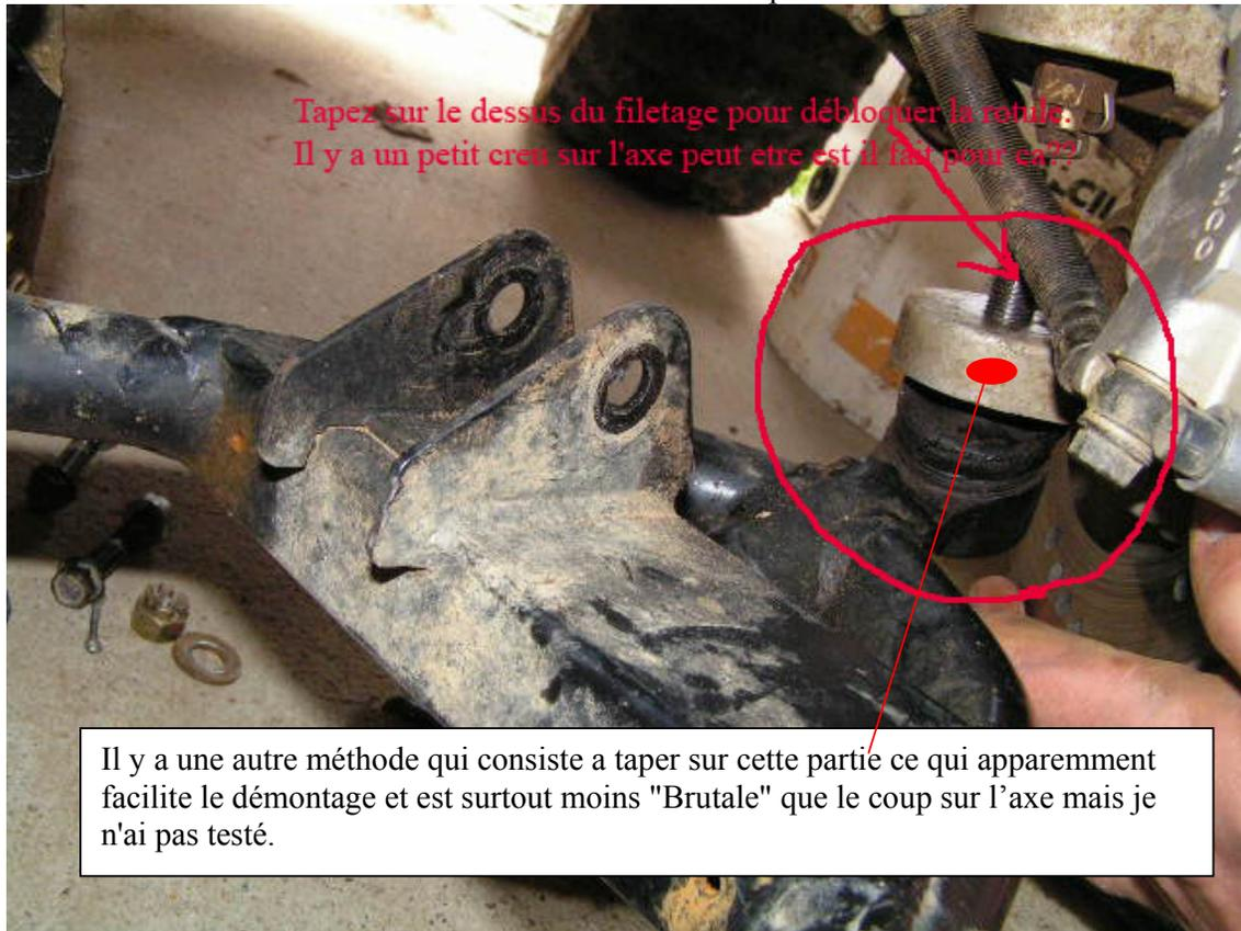
Le triangle est donc maintenant démonté. Pour changer le soufflet il faut un petit tournevis qui permet d'enlever les clip de maintien
