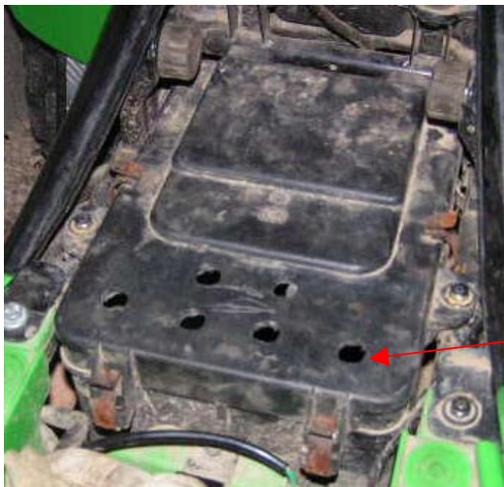
La dernière opération consiste à amener plus d'air au carbu, soit en changeant le filtre à air, soit en ouvrant la boîte à air. Pour cela, j'ai fait 6 trous de Ø13 dans le couvercle de la boîte à air(un filtre sur ces trous sera peut être nécessaire).
