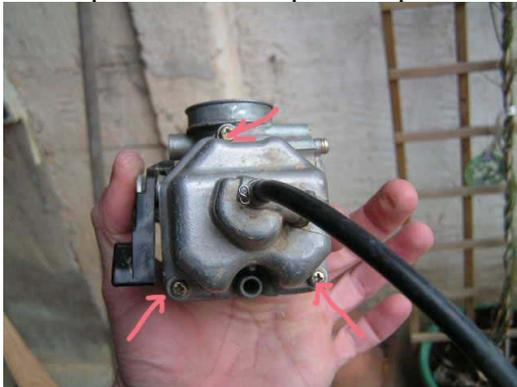
Pour cela, démonter la cuve du carbu en dévissant les 3 vis en dessous.
