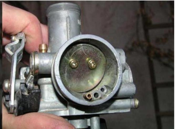
Pour gagner un peu de volume d'air, il suffit de dévisser les deux petites vis et de retirer le papillon. Ensuite, l'axe se sort par la gauche.
